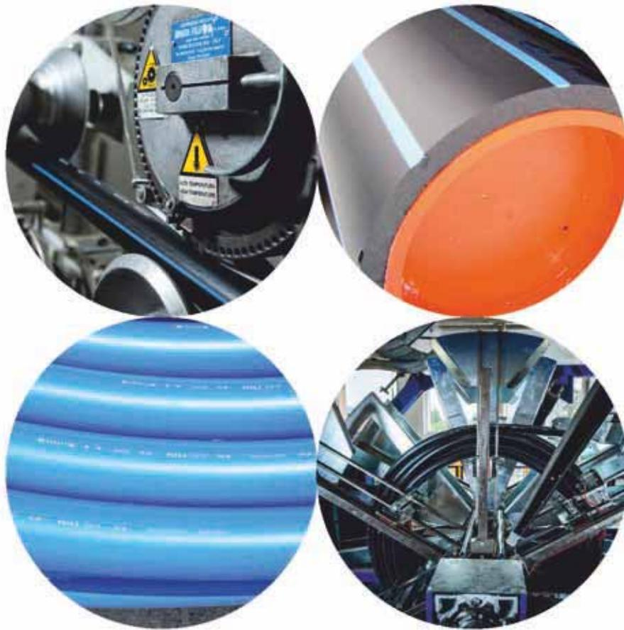
Potrubí z vysokohustotního polyetylenu PE 100 RC (RC = Resistant to Crack) – chová se obdobně jako dosud běžně používané materiály typy PE 100+, díky speciální výrobě granulátu došlo ke vzniku pevnějších vazeb v řetězcích jednotlivých makromolekul.
